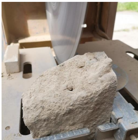
Slika 1. Rezanje uzoraka iz velikih komada nabijene zemlje
