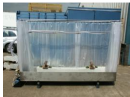
Slika 2. Oprema za prskanje s okvirom, spremnikom i pumpom za vodu
